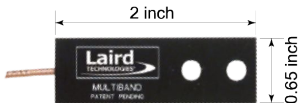
図 19.3 無線 LAN 用基板アンテナ形状
