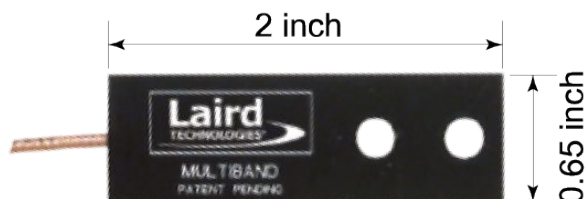
図 19.3 無線 LAN 用基板アンテナ形状
