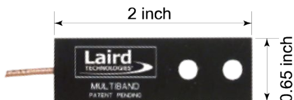
図 19.3 無線 LAN 用基板アンテナ形状
