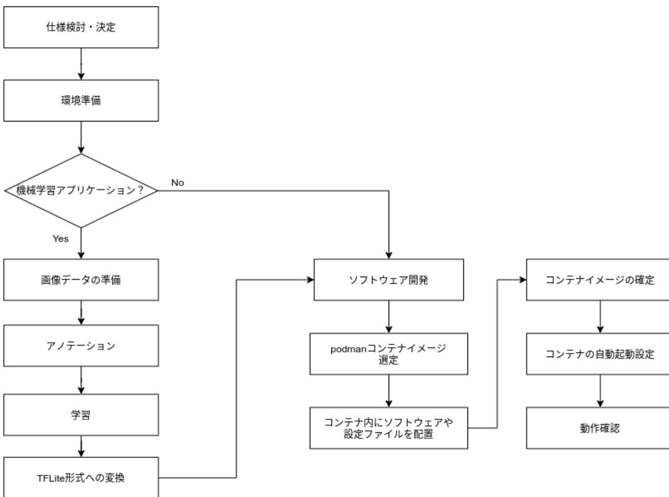
図 2.1 Armadillo Base OS 上でのシステム開発の流れ
