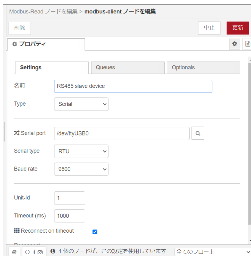
図 4.11 [modbus-client] ノードのプロパティ内容
