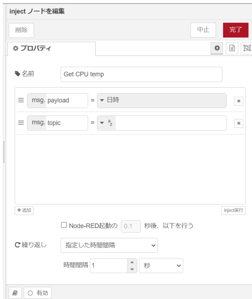
図 4.7 [inject] ノードのプロパティ内容
