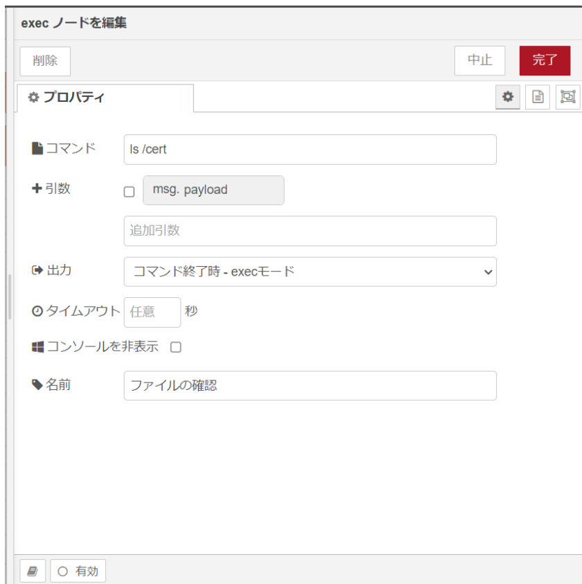
図 4.32 [ファイルの確認] ノードのプロパティ内容
