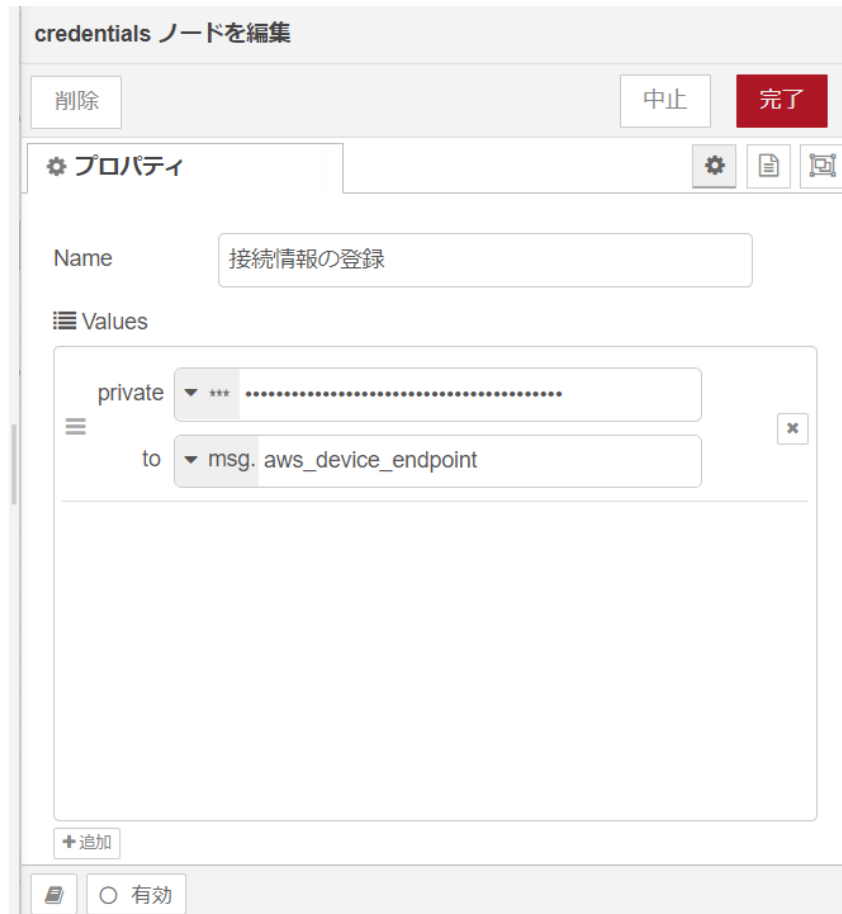
図 4.66 [接続情報の登録] ノードのプロパティ内容
