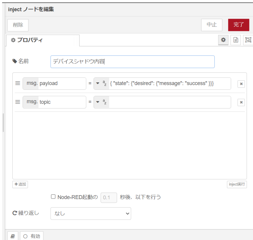
図 4.65 [デバイスシャドウ内容] ノードのプロパティ内容
