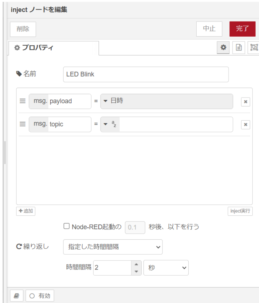
図 4.3 [inject] ノードのプロパティ内容
