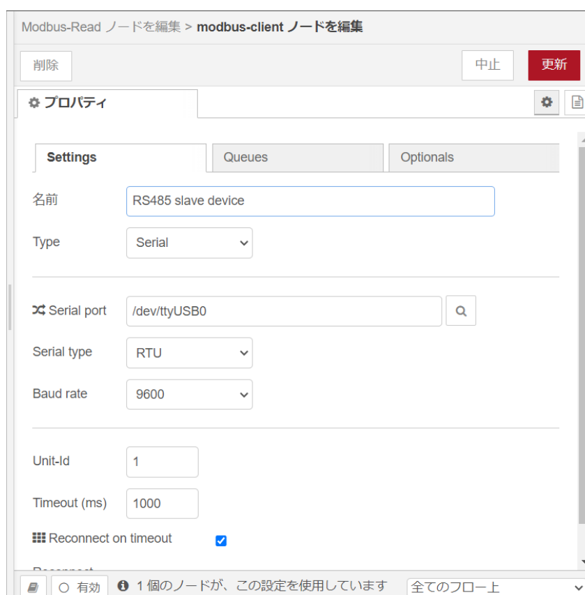
図 4.11 [modbus-client] ノードのプロパティ内容
