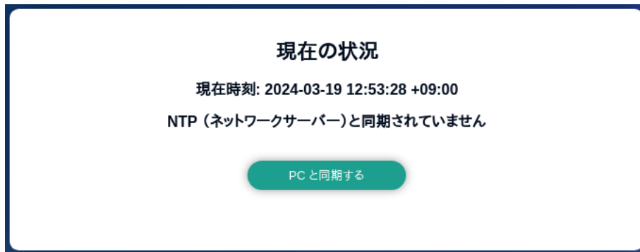
図 6.94 ネットワークタイムサーバーと同期されていない場合の状況確認画面
