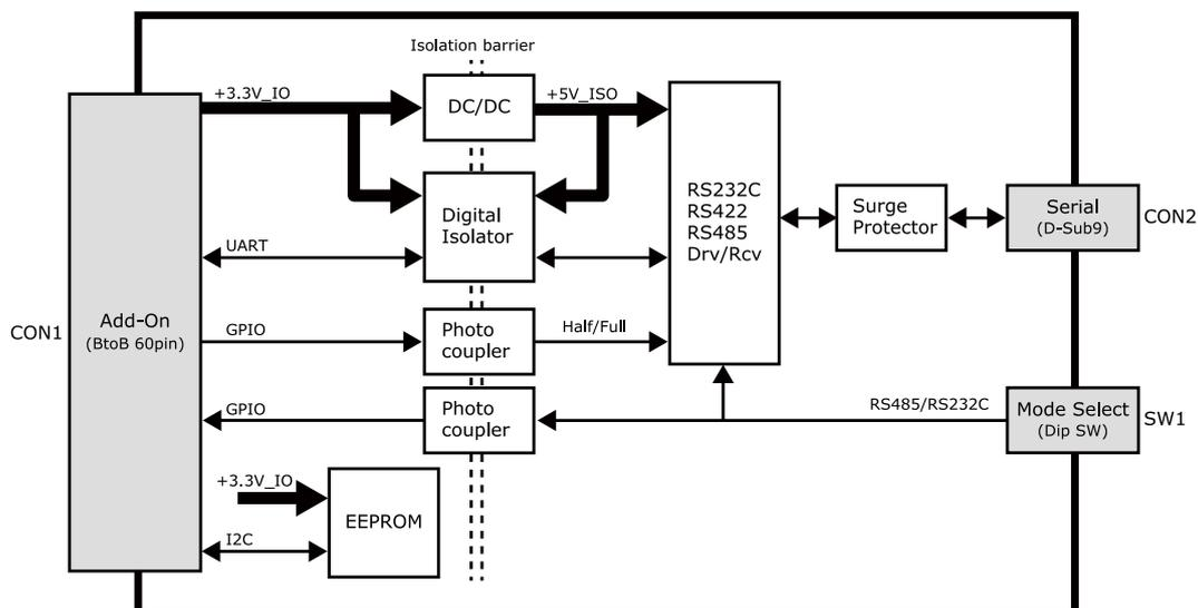
図 18.4 絶縁シリアルアドオンモジュール ブロック図
