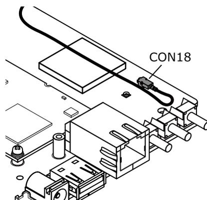
図 19.2 アンテナケーブルの取り付け
