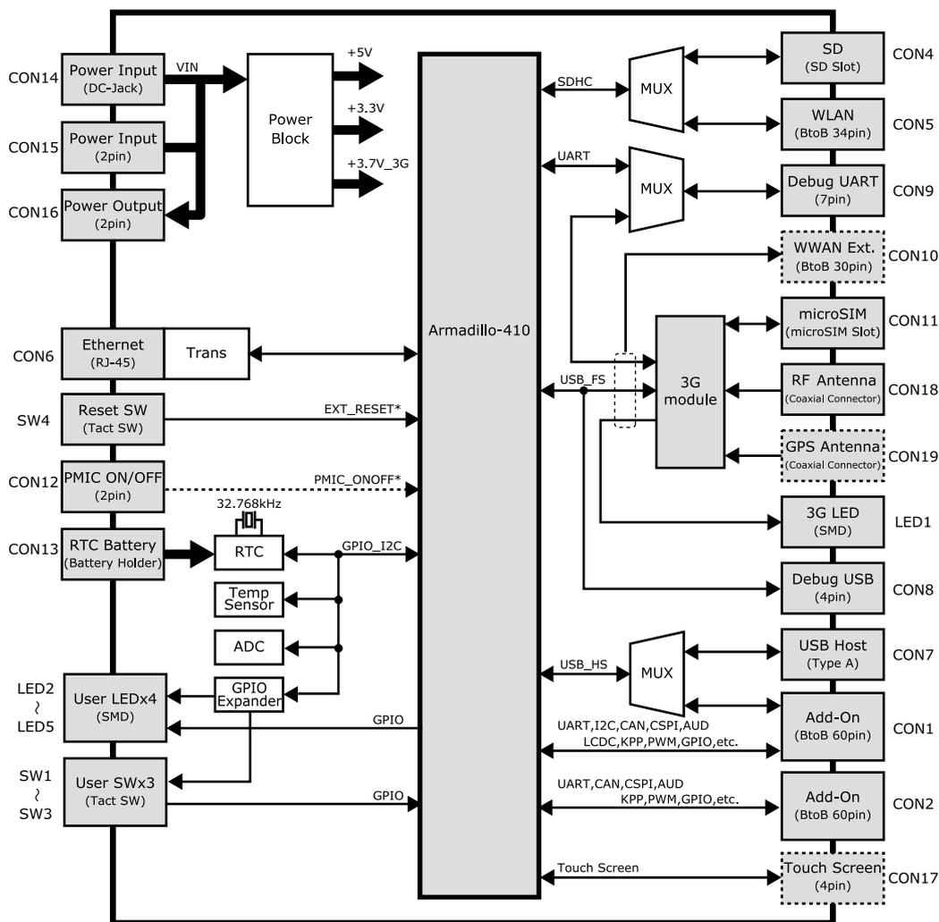
図 3.2 Armadillo-IoT ゲートウェイ ベースボード ブロック図(AG421-D00Z、AG421-C00Z)<sup>[1]</sup>
