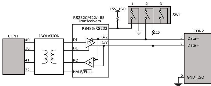
図 18.8 RS422/RS485 半二重に設定時の接続
