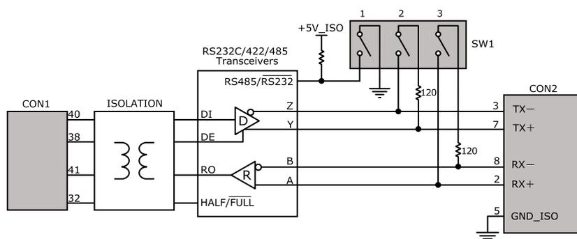
図 18.7 RS422/RS485 全二重に設定時の接続
