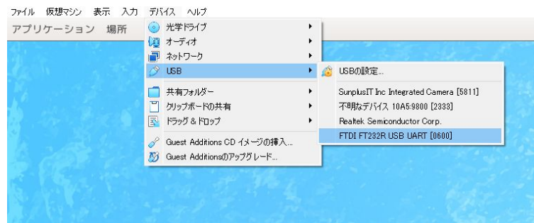
図 4.1 ATDE にデバイスを接続する
