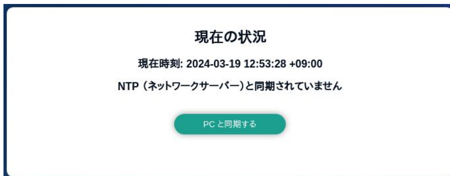
図 6.109 ネットワークタイムサーバーと同期されていない場合の状況確認画面
