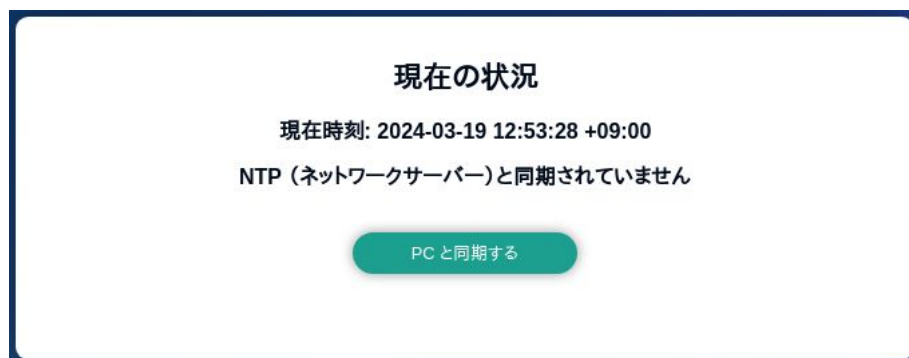
図 6.113 ネットワークタイムサーバーと同期されていない場合の状況確認画面
