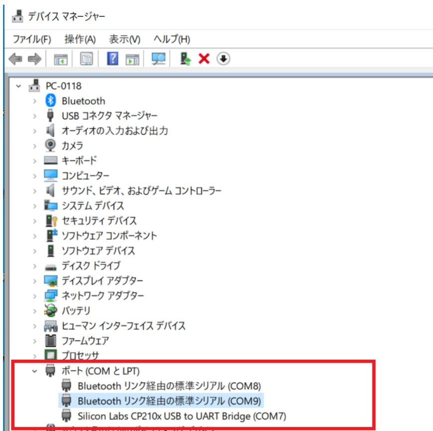
図 3.16 Bluetooth に割当の COM を変更した状態
