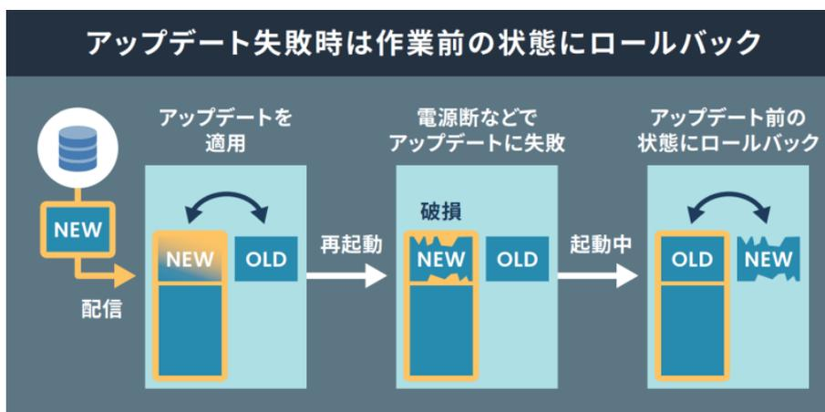
図 2.7 ロールバックの仕組み
