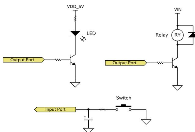
図 3.28 スイッチ、LED、リレー接続例
