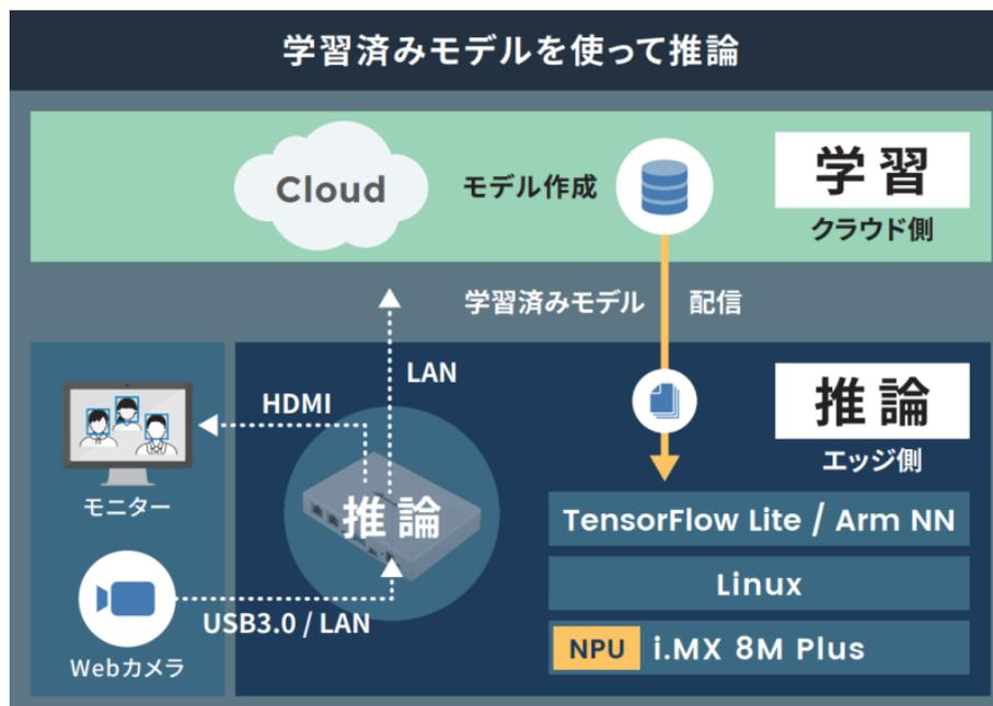
図 2.3 エッジ AI 処理、機械学習の例
