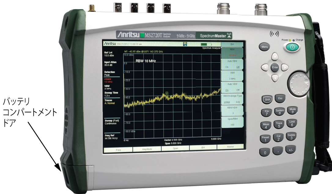
図 1-1. バッテリ コンパートメントのドア
